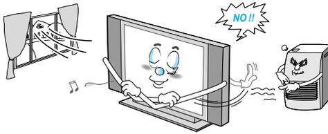
Suministre ventilación al monitor. Esta unidad está diseñada con ranuras para ventilación en el gabinete para protegerla de sobrecalentamiento. No obstruya estas aberturas con ningún objeto y no coloque el monitor sobre la cama, sofá, alfombra u otra superficie similar. No lo coloque cerca de un radiador o registrador de calor. Si coloca el monitor en un estante o biblioteca, asegúrese de que tenga ventilación adecuada y de que haya seguido las instrucciones del fabricante para montarlo.
