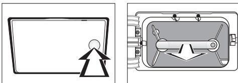
Le filtre mousse est situé en bas à gauche, derrière la trappe. Le filtre mousse collecte les peluches, cheveux et restes de lessive qui parviennent à traverser les tamis des filtres à peluches.
