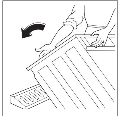
2. Retire o cabo de alimentação e o tubo de escoamento dos suportes do tubo na parte de trás do aparelho.
