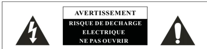
Le symbole de l'éclair dans d'un triangle équilatéral sert à avertir l'utilisateur qu'il existe à l'intérieur de l'appareil, des pièces qui sont sous une tension suffisamment haute pour constituer un risque d'électrocution.
