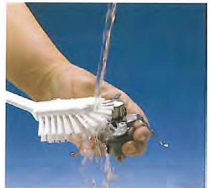
**Atención:** En ningún caso las cuchillas deben permanecer sumergidas en el agua o ser lavadas en lavavajillas, ya que el agua o el detergente pueden destruir los cojinetes de las mismas.
